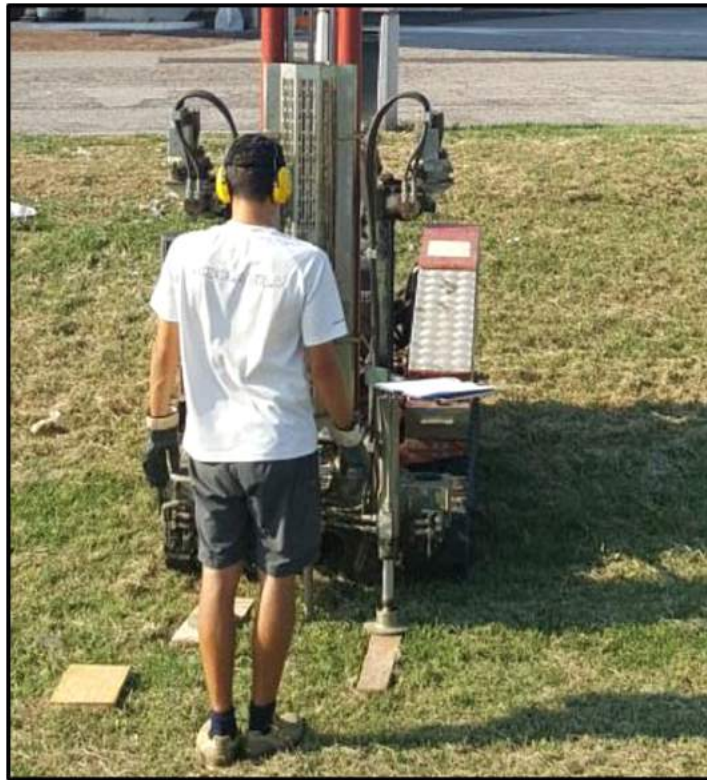
FOTO N. 3 – Prova Penetrometrica Dinamica DPHS2
