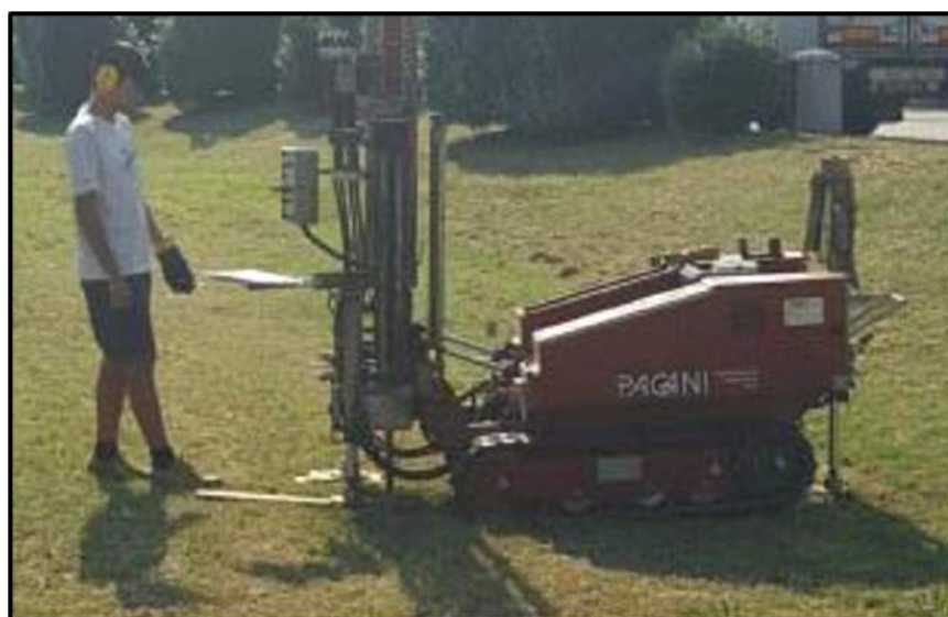
FOTO N. 2 - Prova Penetrometrica Dinamica DPH1
