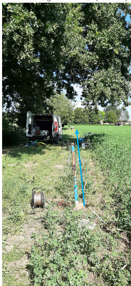
Foto 3 Particolare asse Y (Esac) ove è stata eseguita anche Masw (freccia blu)
