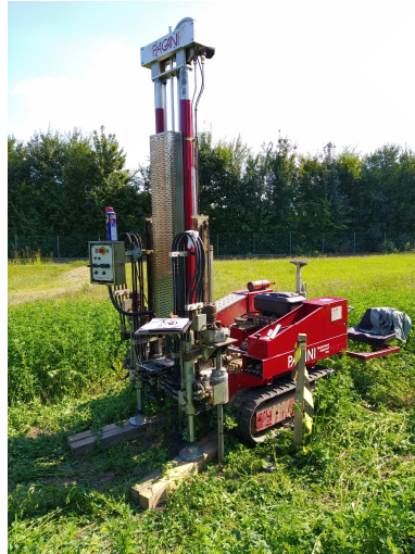
Foto6: particolare esecuzione Cpt 3
