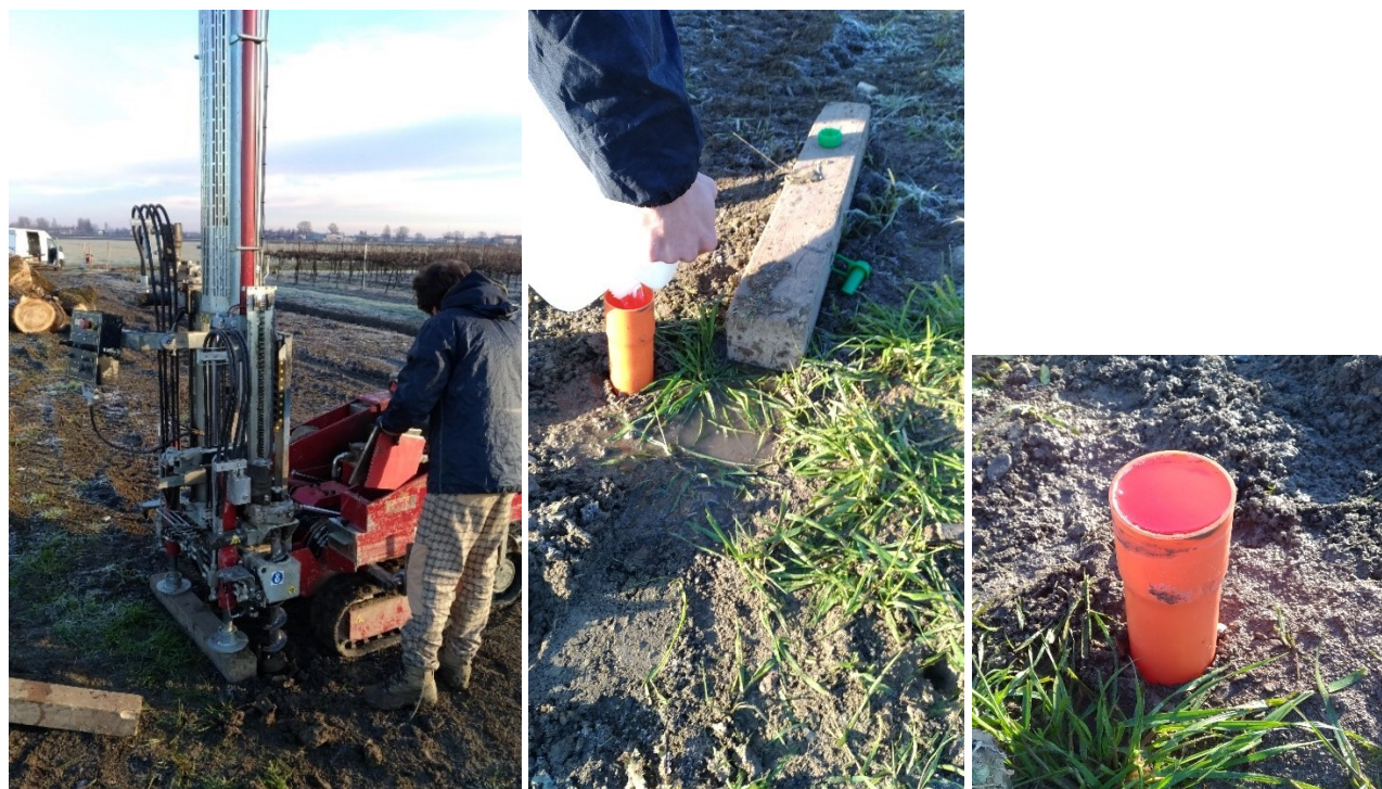
Figura 9: Esecuzione prova di permabilità in sito tipo Lefranc: Esecuzione colonna di perforazione tramite trivella eleicoidale idraulica, riempimento della colonna rivestita sino al bordo superiore del tubo, osservazione degli abbassamenti di livello nel tempo.
