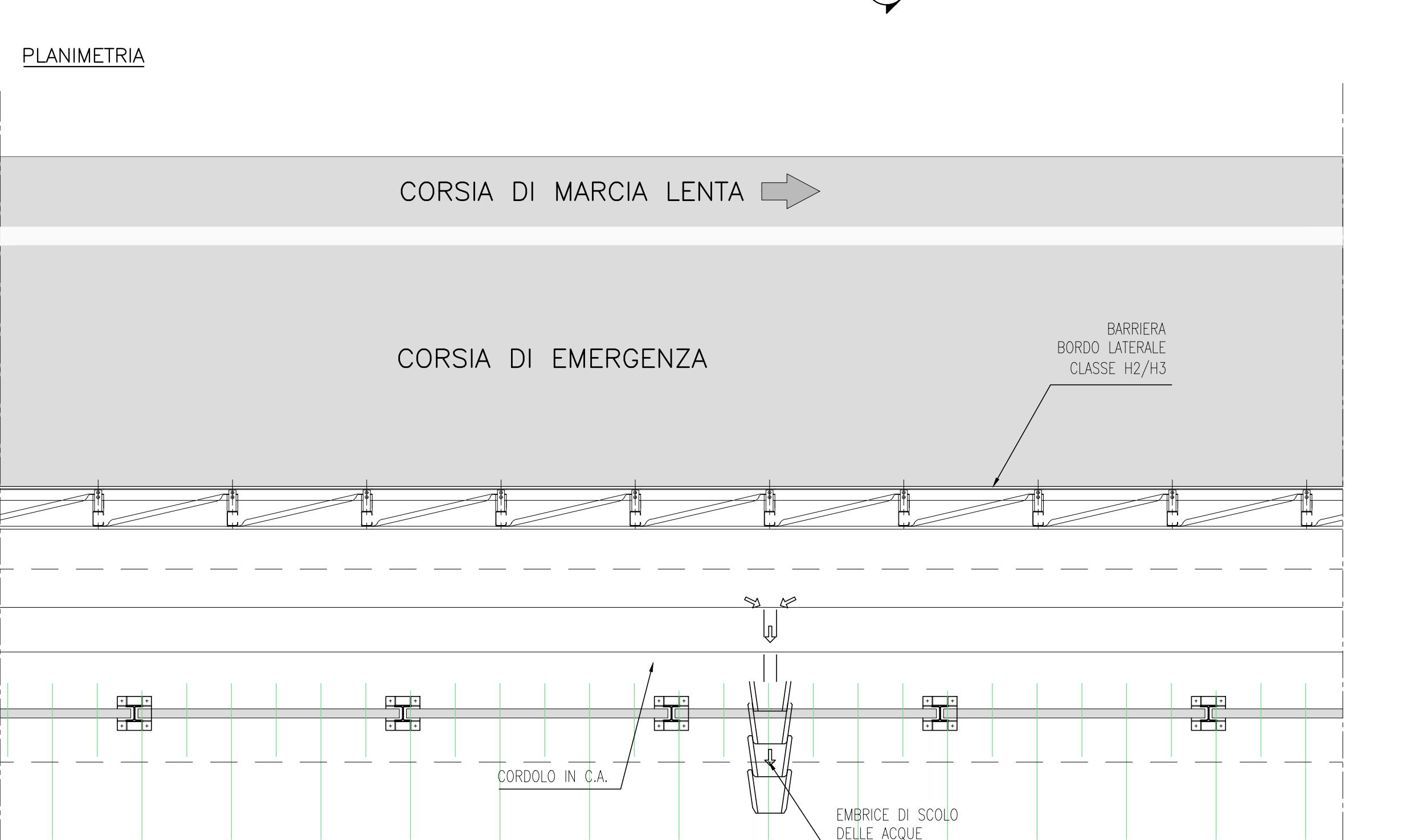
ST-05 BARRIERA DA BORDO LATERALE CON FONDAZIONE SU MURO CON MICROPALI
