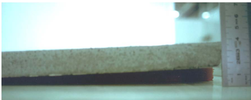
Figura 17-6 - Misura della concavità ai lembi estremi del provino di una malta che ritira all'aria
