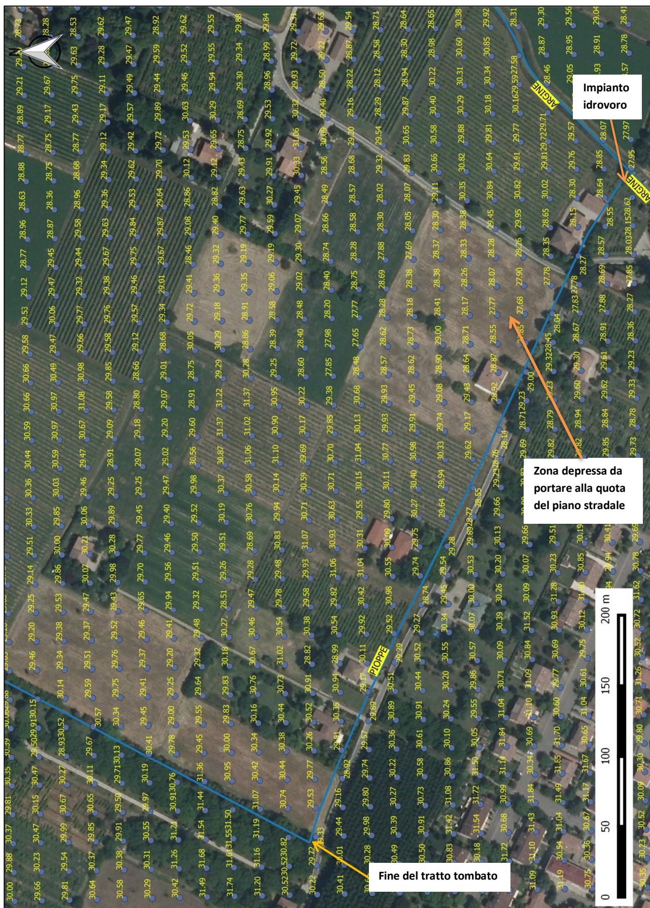
Figura 26: Piano quotato della zona in esame.
